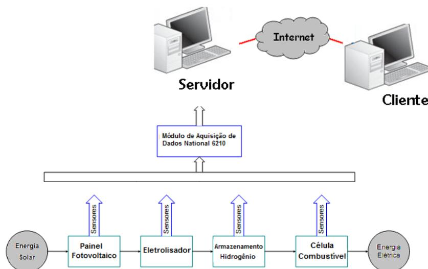
Figura 5 – Diagrama em bloco do sistema supervisório.
